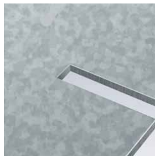
Prostřížení a odlopení třísek v jedné pracovní operaci
