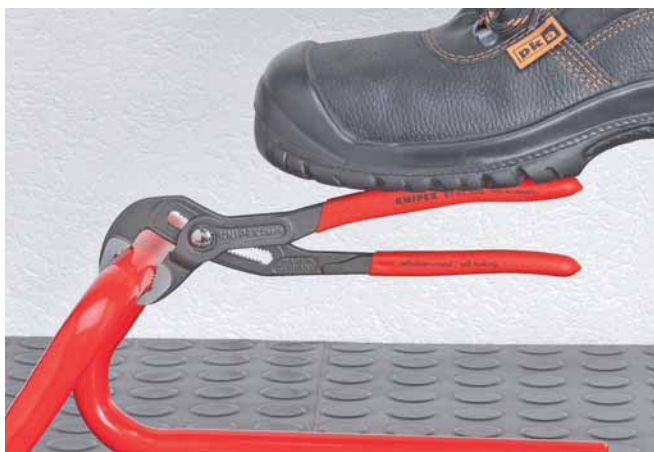
Zuby přesazené proti směru otáčení způsobují samosvorný efekt a zabraňují sklouznutí po obrobku.
