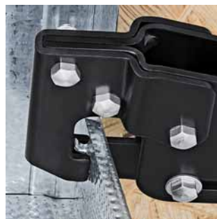
Nasazení kleští na dva spojované profilované plechy
