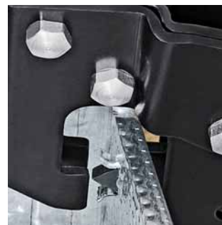
Lisovací nástroj je stlačován profilovanými plechy
