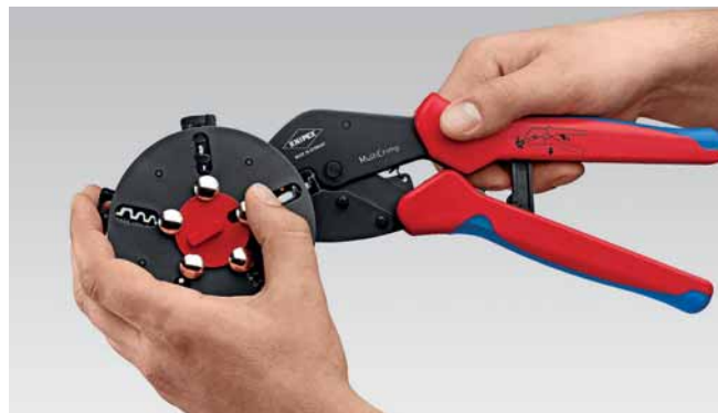
Výměna krimpovacího nástavce: Odaretujte polohu zásobníku, sejměte krimpovací nástavec z kleští.
