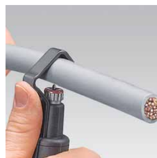
Nastavení nástroje pro obvodový řez
