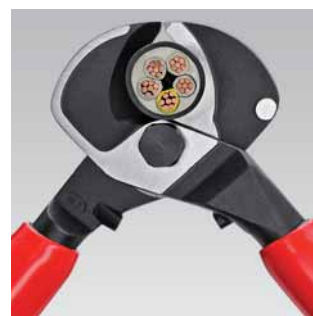
Velká kapacita: max. Ø 27 mm / 150 mm 2
