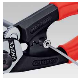
Nalisování koncovky na kryt bovdenu
