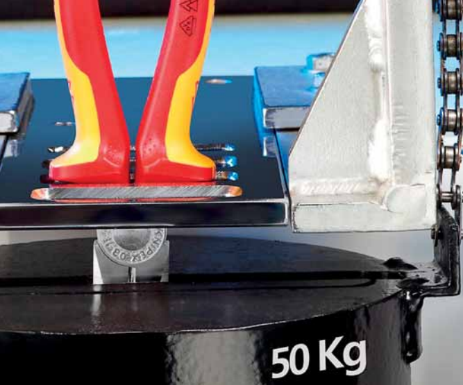
Zkouška přilnavosti izolovaných rukojetí s 500 N.
