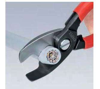
Nachschnitt: Bei größerem Kraftbedarf (Schneiden der Leiter) ist ein Nachsetzen in das Schneidenprofil am Gelenk möglich. Vorschnitt vorne – Nachschnitt hinten
