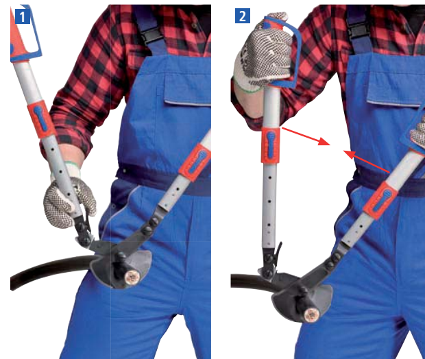
Einstellen einer günstigen Schenkelweite
