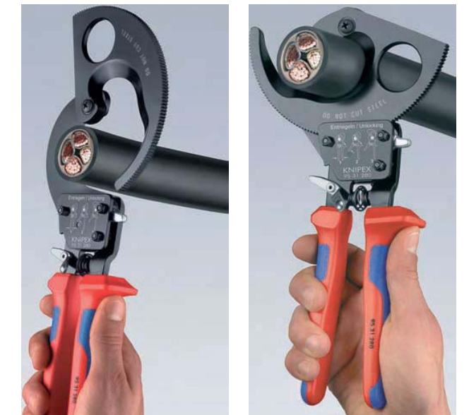
95 31 280 große Kapazität: max. Ø 52 mm / 380 mm² Ratschenprinzip und Zweigang-Zahnkranz-antrieb für kraftsparendes Schneiden
