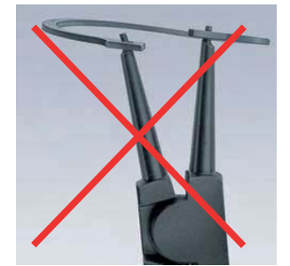
Herkömmliche Sicherungsringzange: Verwindung des Rings bei der Montage möglich
