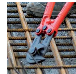
Die besondere Kopfform des Mattenschneiders 71 82 950 ermöglicht das Schneiden flachliegender Baustähle
