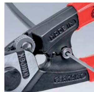
Anpressen der Endkappe an die Bowdenhülle
