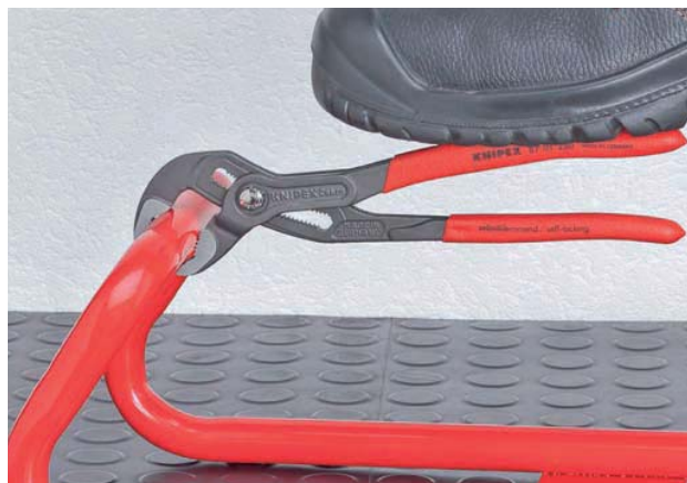
Gegen die Drehrichtung versetzte Zähne bewirken einen Selbstklemmeffekt und verhindern das Abrutschen am Werkstück. Selbstklemmend an Rohren und Muttern: weniger Kraftaufwand
