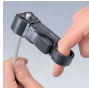
Dreistufiger Schnitt in einem Arbeitsgang
