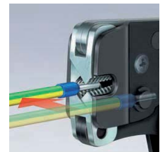
97 53 08: Einführen von Aderendhülsen parallel von der Seite bis 2,5 mm 2 z. B. unter beengten Platzverhältnissen
