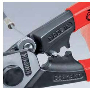
Anpressen der Endhülle an das Zugseil
