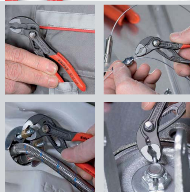
Verstellschlitz für enorme Greifkapazität 30 % mehr als herkömmliche Rohrzanze
