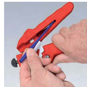
Zum Montagewerkzeug gehören drei Torpedo-Dorne für die verschiedenen Kabelquerschnitte
