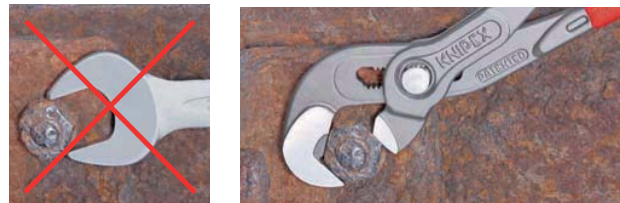
Arbeiten an verrosteter Mutter mit verrundeten Kanten
